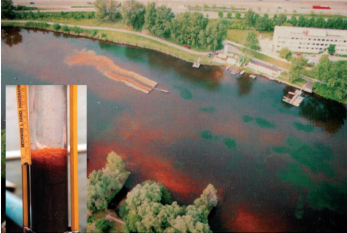
Abb. 5. Das Einbringen von Eisenchlorid (erkennbar an der rotbraunen Farbe) ist einer der beiden Schritte im so genannten RIPLIX-Verfahren, mit dem die Sanierung der Alten Donau in den Jahren 1995 eingeleitet wurde. Durch diese „Chemotherapie“ werden Nährstoffe und Algen gefällt. Im zweiten Schritt werden sie durch Zugabe von Kalziumnitrat im Sediment (kleines Bild) verstärkt abgebaut.
